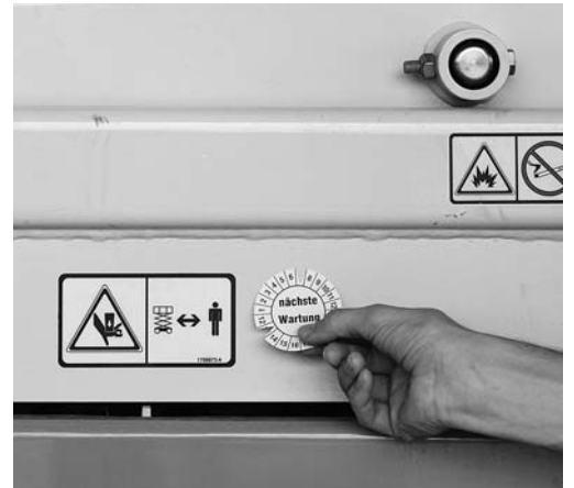
Bild 3: Die Fälligkeit der nächsten Instandhaltung kann zum Beispiel mit einer Prüflakette am Gerät ersichtlich gemacht werden.
