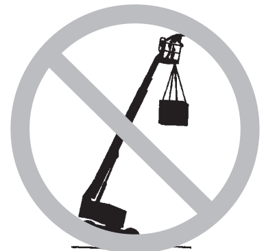
Bild 4: Die Hubarbeitsbühne darf nicht als Kran missbraucht werden.
